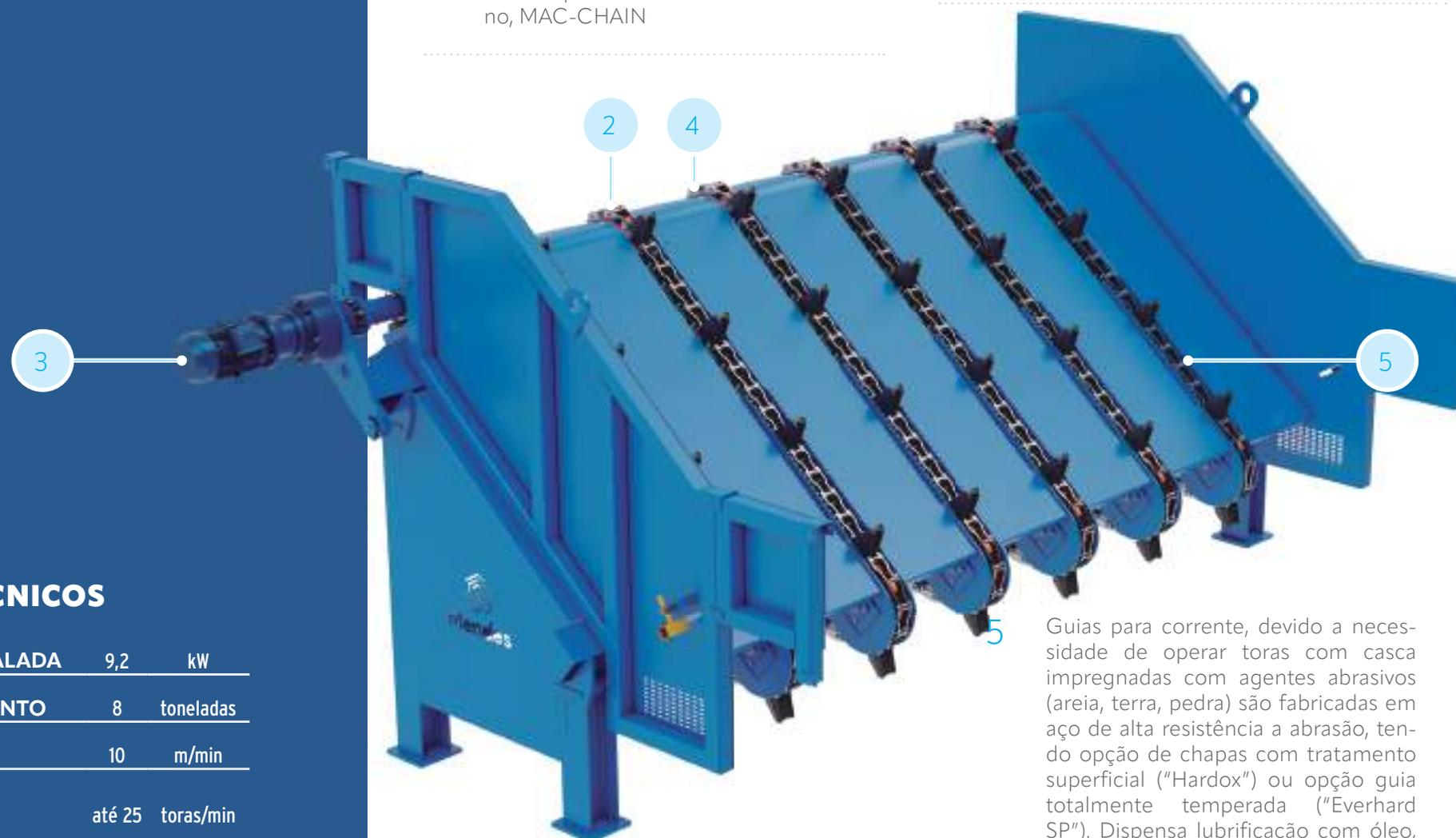
5 Guias para corrente, devido a necessidade de operar toras com casca impregnadas com agentes abrasivos (areia, terra, pedra) são fabricadas em aço de alta resistência a abrasão, tendo opção de chapas com tratamento superficial ("Hardox") ou opção guia totalmente temperada ("Everhard SP"). Dispensa lubrificação com óleo, somente água.
